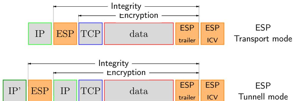
Figura 34: incapsulamento ESP
