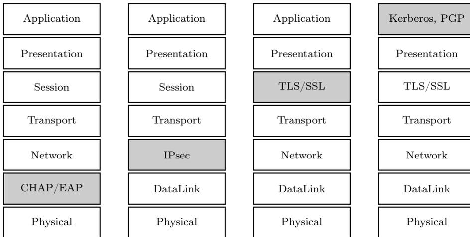
Figura 25: Crittografia ai diversi livelli ISO/OSI
