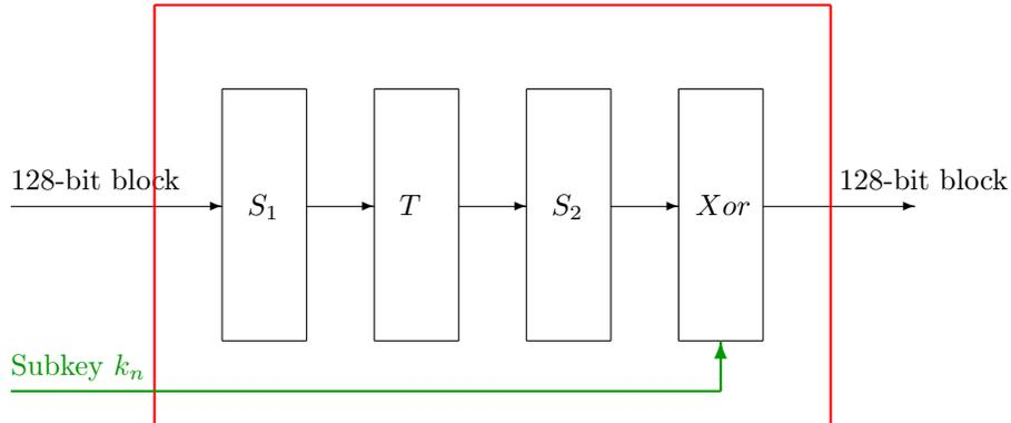
Figura 6: dettaglio round  $R_n$  AES
