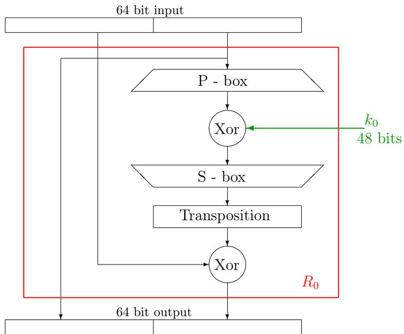
Figura 4: DES: dettaglio del singolo round  $R_0$
