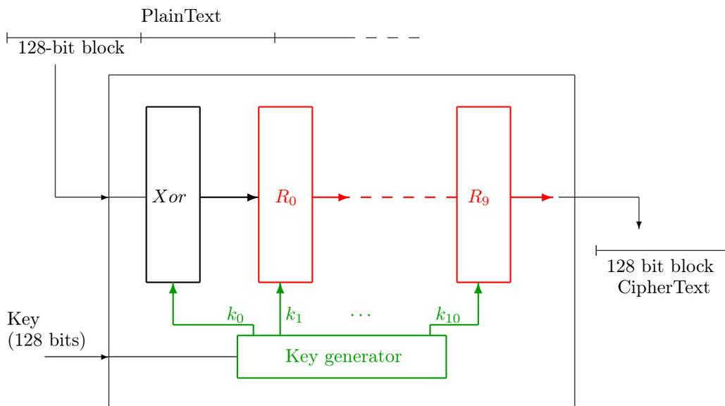
Figura 5: schema a blocchi AES
