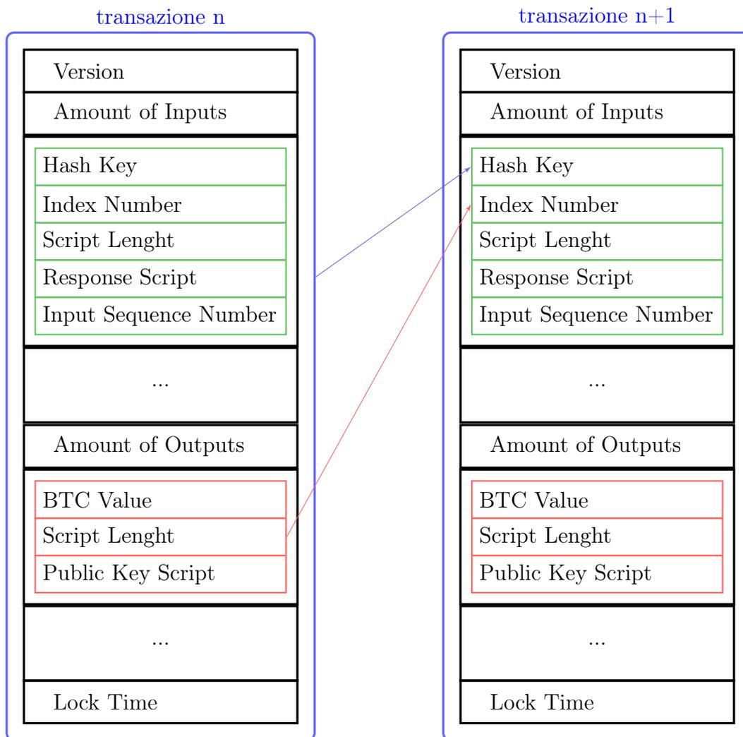
Figura 28: dettaglio dei campi di una transazione Bitcoin
