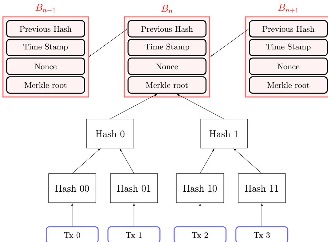
Figura 30: dettaglio di un nodo della blockchain
