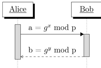
Figura 8: UML di sequenza DH Key Exchange
